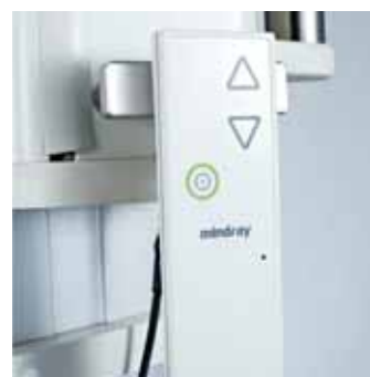
Модуль управления подъемом 1: проводной пульт ручного управления
